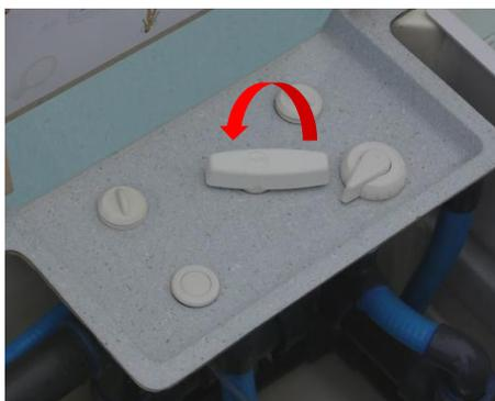
Placez la vanne de commande en position INTERMEDIAIRE.
