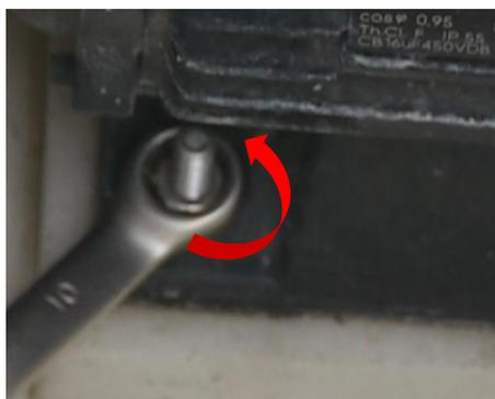
Démontez la pompe à l'aide d'une clé de 13 mm.
