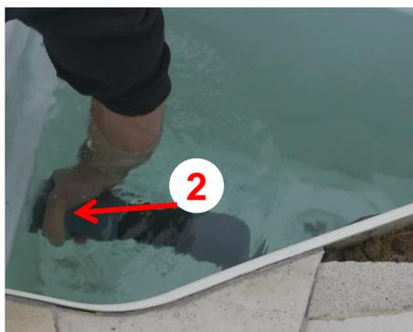
Dévissez l'écrou ② situé dans la cuve de filtration et récupérez le joint.
